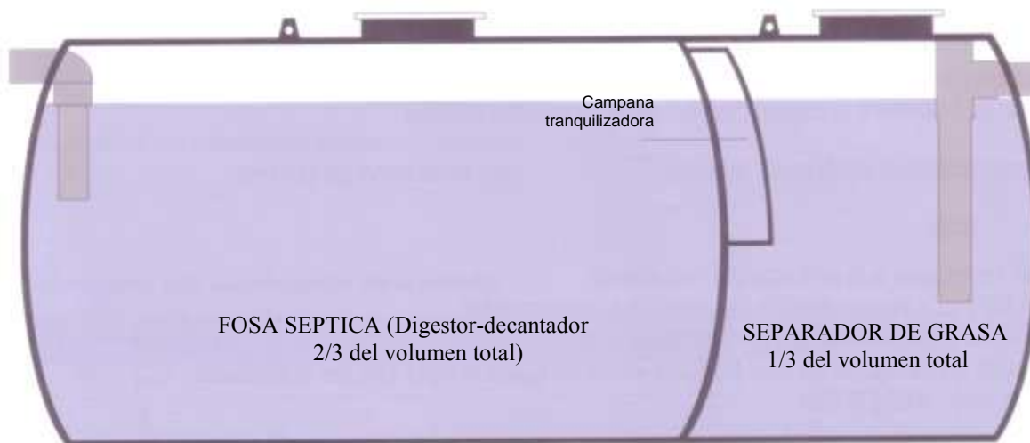
FOSA SÉPTICA + SEPARADOR DE GRASAS HORIZONTAL
